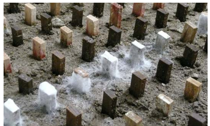
Abbildung 3: Lagerung der Prüfkörper im Erdesubstrat in Anlehnung an ENV 807
