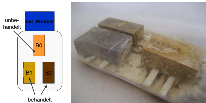
Abbildung 2: Lagerung je eines Behandlungs- und eines Kontrollprüfkörpers in Laborflaschen (9,4x9,4x140mm) für die Resistenzprüfung in Anlehnung an EN 113
