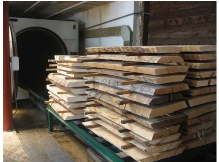
Abbildung 1: Thermoholzbehandlung in einer Druck-Vakuumanlage des Anlagenherstellers Wood-Treatment-Technology (WTT)
